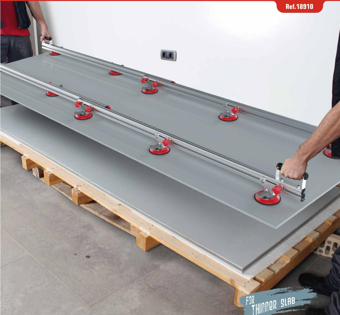
**ES** Especialmente diseñado para la manipulación de láminas cerámicas.
