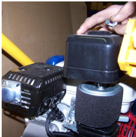
Obr. Kontrola čističe vzduchu motoru
